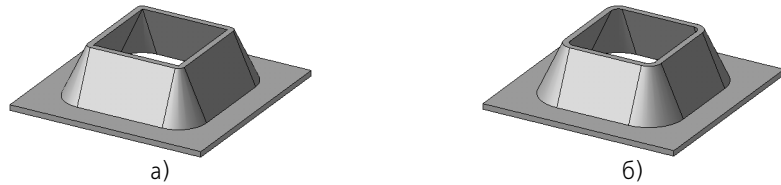
Рис. 101.5. Открытая штамповка с уклоном боковых стенок и скругленными боковыми ребрами: а) радиус скругления равен нулю, б) радиус скругления больше нуля
