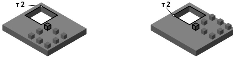
Рис. 93.5. Зависимость между расположением копий и положением точки начала копирования (траектория копирования и исходный элемент выделены)
