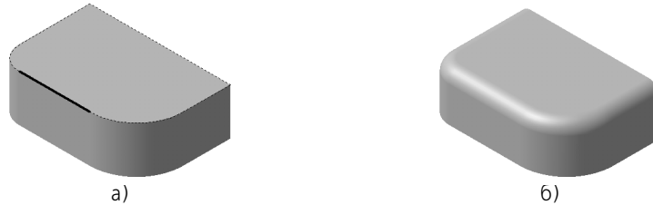
Рис. 91.2. Скругление: а) для построения скругления указано одно ребро и включена опция Продолжать по касательной , б) результат построения скругления
