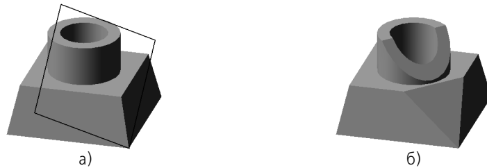
Рис. 92.1. Отсечение части детали плоскостью: а) исходное состояние детали (плоскость отсечения обозначена условно), б) результат выполнения операции отсечения
