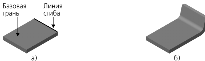
Рис. 97.9. Сгиб вдоль ребра: а) базовая грань и линия сгиба, б) результат построения
