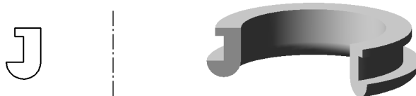
Рис. 83.4. Эскиз и элемент, образованный операцией вращения
