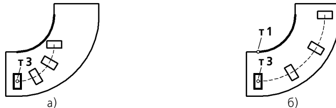
Рис. 93.4. Схема копирования элемента выдавливания вдоль всей направляющей с сохранением ориентации (направляющая и исходный элемент выделены): а) положение базовой точки определяется автоматически, б) в качестве базовой точки выбрана точка 1
